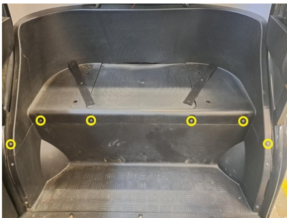
Irrota takaistuimen rungon kiinnitysruuvit. (ristipäämeisseli ph2).
