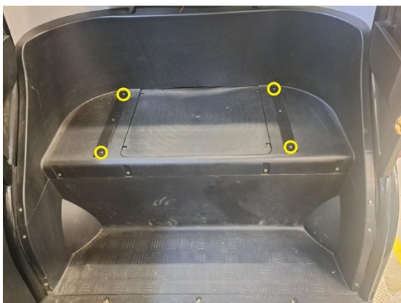
Irrota velcro tarranauhojen reunimaiset kiinnitysruuvit. (ristipäämeisseli ph2).
